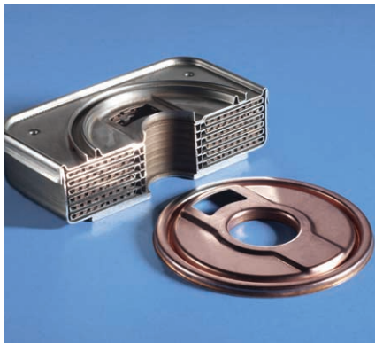
Kfz-Ölkühler aus kupferplattiertem korrosionsbeständigem Stahl (X5CrNi18-10) Eigenschaften: Kupfer fungiert als Lot
