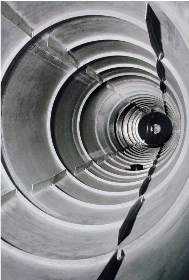
Abb. 2: Anwendungsbeispiele für plattiertes Grobblech Oben: Innenansicht eines Mantelschusses für einen chemischen Reaktor, sprengplattiert mit Zirkon 702 low oxygen Rechts: Innenansicht eines Rauchgaswäschers, warmwalzplattiert mit NiCr23Mo16Al
