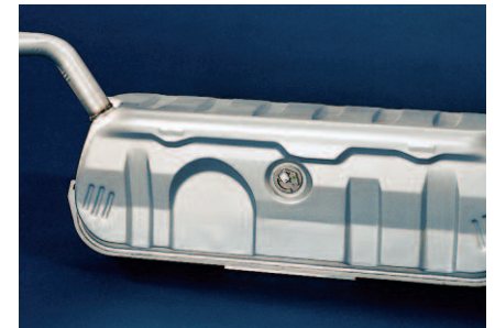
Abb. 12: Kraftfahrzeugtank aus Feinblech mit Aluminium-Silizium-Überzug (AS)
