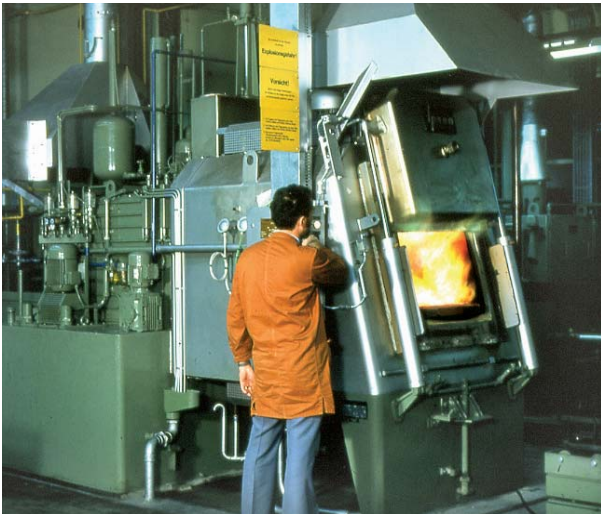
Bild 45: Prozessgas-Kammerofen zum Einsatzhärten (Fa. Ipsen)
