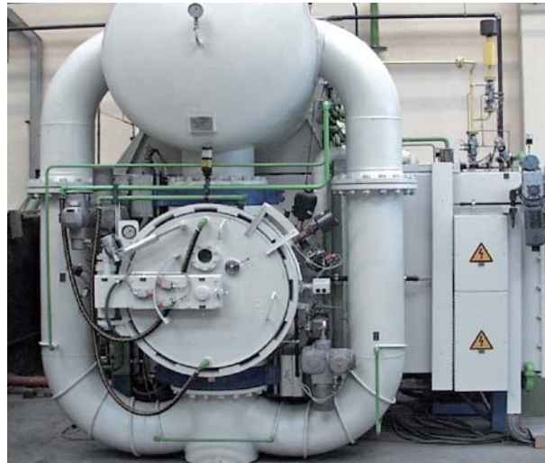
Bild 47: Vakuumofen zum Einsatzhärten (Fa. Aichelin)
