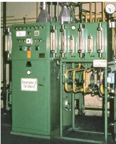
Bild 46: Endogasgenerator (Fa. Ipsen)
