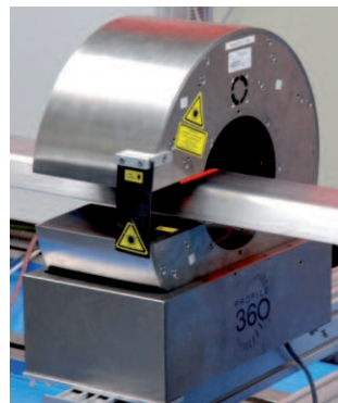
Abb. 26: Geometrieerfassung mit Bytewise 360 am Beispiel der Ermittlung des Biegewinkels
