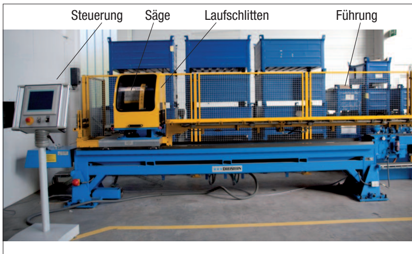
Abb. 13: Aufbau einer fliegenden Säge
