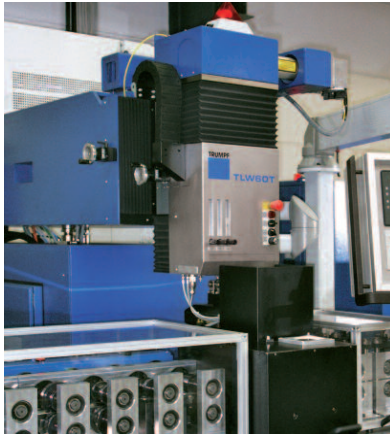
Abb. 24: Einsatz von CO 2 -Lasern beim Profilieren [53], [38]
