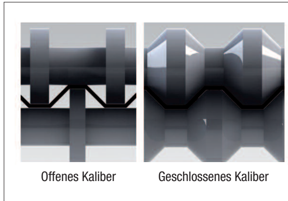
Abb. 19: Möglichkeit einer segmentierten Rollenordnung (offenes Kaliber) und Anordnung vollständiger Rollen (geschlossenes Kaliber)
