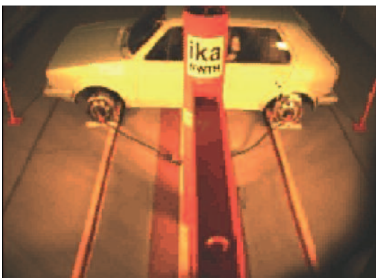
Abb. 8: Pfahlaufprall in Querrichtung mit 35 km/h
