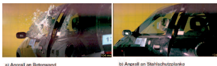
Abb. 21: Simulierter Crash gegen a) Betonwand, b) Stahlschutzplanke
