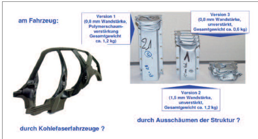
Abb. 23: Energieaufnahme durch Fahrzeugstrukturen
