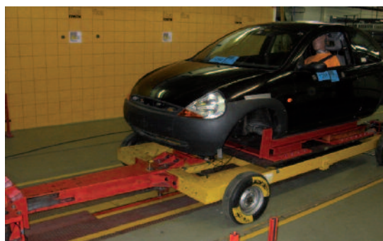
Abb. 20: ika-Crashversuch zur Verknüpfung von HIC und ASI
